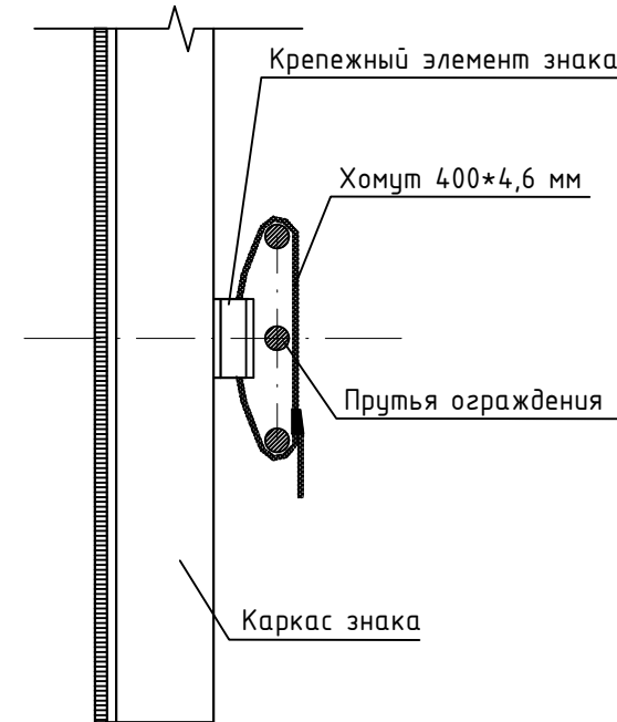
Узел крепление каркаса знака к ограждению
